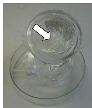
写真 1 アニオン交換膜（矢印）を内筒（倒立の状態）の底に固定リングによりセット
