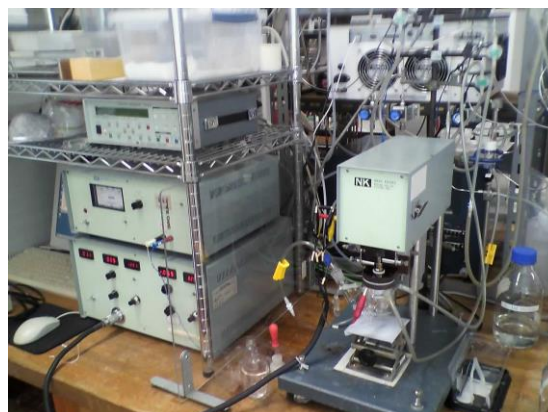
写真 1 回転リング・ディスク電極装置
