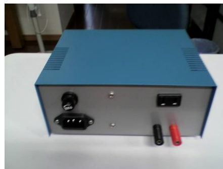
写真1 左下：AC電源ソケット、右上：ヒーター用出力、右下：熱電対入力
