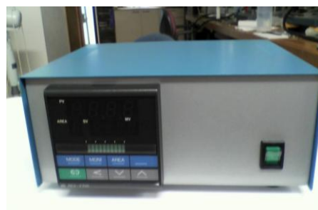
写真 2 左：制御用パネル、右：主電源スイッチ
